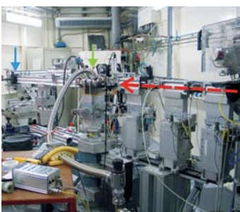
Der Röntgenstrahl (roter Pfeil) wird an der Probe, die sich in einem Hochtemperaturofen (grüner Pfeil) bei ca. 800° C befindet, gestreut. Die Bilder werden mit einem Detektor (blauer Pfeil) im Sekundentakt aufgenommen.
